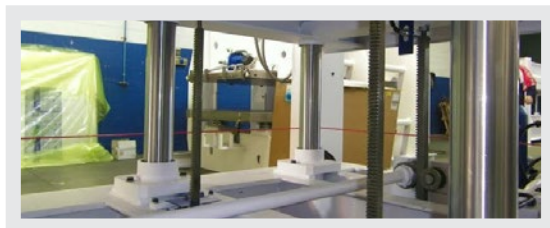
Solidne tłoki wraz z prowadzeniem na pionowych zębatkach
